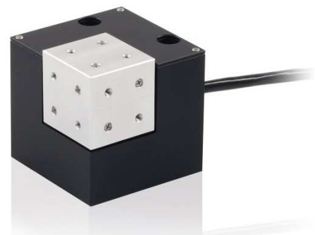
Fig. 4 NanoCube®是一款基于压电的高动态 3 轴扫描仪，行程范围为 100 微米。除了纳米级分辨率和超高速外，这种基于柔性铰链的子系统还可以无磨损地执行连续跟踪。
