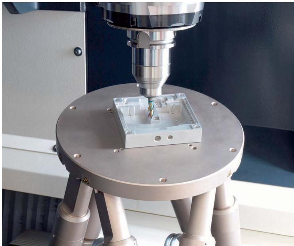
标准化现场总线接口使集成变得更加容易：自动化技术中的六足位移台
