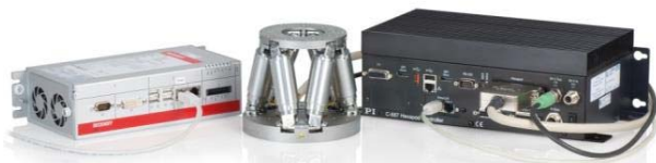
Abb. 2 Feldbusschnittstellen gibt es aktuell als austauschbare Module für PROFIBET und EtherCAT
