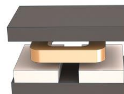
Abb. 2 Voice-Coil-Motor in Flachbauweise
