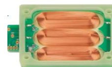
Abb. 12 Beispielhafter Aufbau eines PIMag® eisenlosen Linearmotors ohne Magnetbahn
