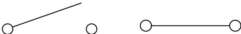
Luftdruck unter dem Schwellenwert, Druckschalter geöffnet (links); Luftdruck über dem Schwellenwert, Druckschalter geschlossen (rechts)
