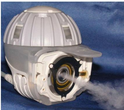
Abb. 3 Die Aerosolerzeugung im Verneblerkopf der eFlow® rapid Electronic Nebulizer Serie basiert auf einer perforierten Edelstahlmembran, die von einer ringförmigen Piezoscheibe zu Ultraschallschwingungen angeregt wird (Pari Pharma GmbH)
