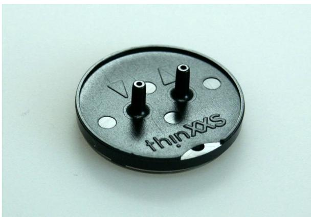
Abb. 5 Spezifische Piezoscheiben ermöglichen die präzise Dosierung von Flüssigkeiten und Gasen mit der Mikropumpe von ThinXXS. Die entsprechende Regelung sorgt auch bei Gegendruck für hohe Förderraten, indem die Schaltfrequenzen oder die Amplitude der Piezoauslenkung variiert werden (thinXXS Microtechnology AG)
