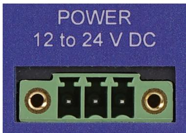
Abbildung 6: Pins von links nach rechts: 1 bis 3
