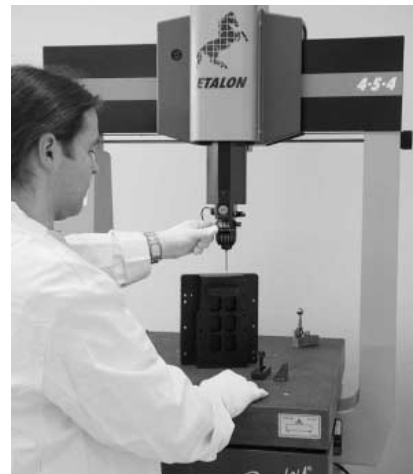
Abb. 11: Überprüfung einer Präzisions-Mechanik an der 3D-Koordinatenmeßmaschine.
