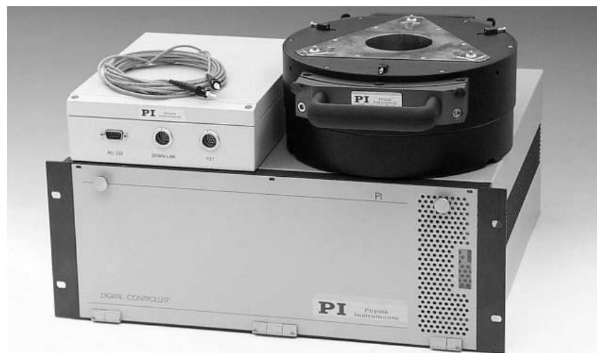
Abb. 4: 250 mm Tip/Tilt Steering-Mirror-Einheit (ohne Spiegel) mit Digital-Controller und ultraschnellem Cap-SensorController/Fiber-Link-Interface für Keck Outrigger Telescope in Hawaii. Insgesamt werden 4 Teleskope aufgebaut. Kippbereich: \pm 150 \mu\text{rad} , Auflösung: NanoRad-Bereich.
