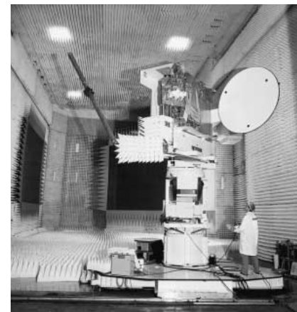
Abb. 3, Test Raum im Alcatel Space Compact Antenna Test Range. Bild: Alcatel Space
