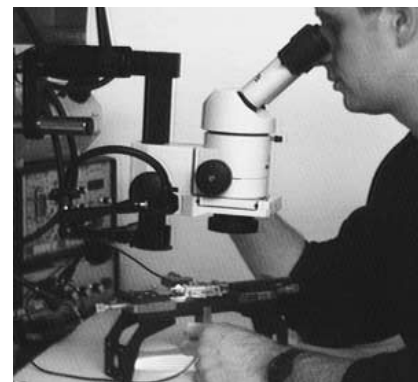
Abb. 2, Arbeitsplatz zur Faser-Chip-Montage. Bild: HHI
