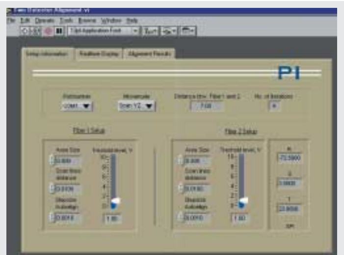
LabView™ Treiber für automatische Faserbündeljustage sind Bestandteil der F-206 Software.
