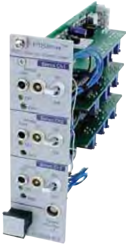
Das E-509.E3 Modul vereint Sensorauswertung- und Positionsreglerfunktionen für drei Kanäle
