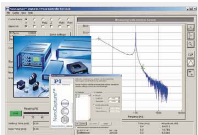
Piezosysteme komfortabel bedienen und optimieren, hier: Die Frequenzantwort eines Nanopositioniertisches im Bodeplot
