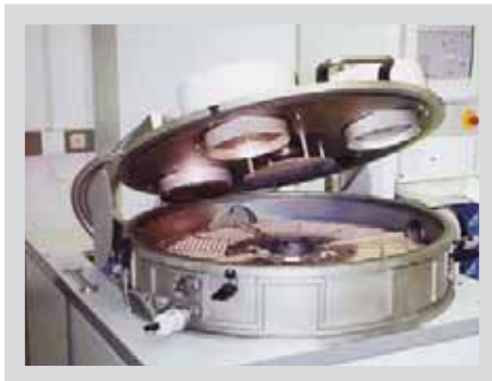
Vakuum-Beschichtung (Sputtern) von Piezokeramiken
