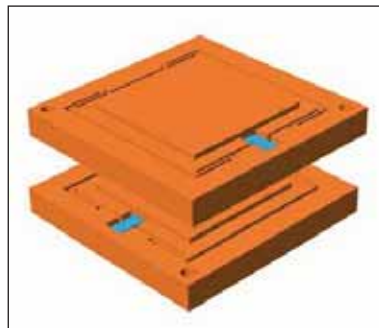
Prinzipdarstellung eines gestapelten XY-Piezostellstisches (Seriellkinematik)
