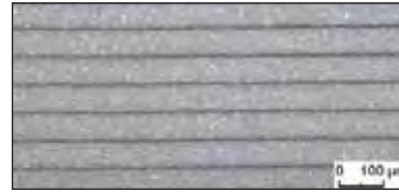
Piezokeramik-Schichten in einem monolithischen Aktor (LVPZT)
