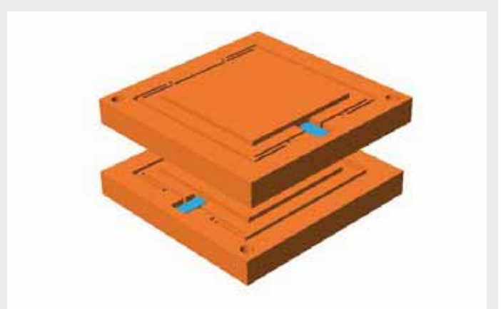
Abb. 50a. Prinzipdarstellung eines gestapelten XY-Piezostellisches (Seriellkinematik). Nachteile gegenüber Parallelkinematiken sind: Höheres Massenträgheitsmoment, höherer Schwerpunkt, bewegte Kabel (können Reibung und Hysterese verursachen). Integrierte Parallelmetrologie und automatische Führungsfehlerkompensation (Active Trajectory Control) sind nicht möglich
