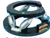
6-achsige Parallelkinematik (Hexapod) mit N-215 NEXLINE® Hochlast-Aktoren für den Einsatz unter starken Magnetfeldern. Das System wird von sechs einzelnen E-755 über eine externe Software und Hardware zur Koordinatentransformation gesteuert
