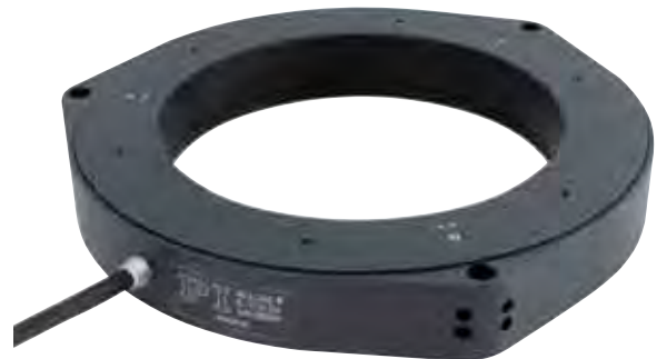
Z, Tip, Tilt Plattform mit NEXLINE® Piezoschreitmotoren und Positionsregelung: Durchmesser 300 mm (12"), Belastbarkeit 200 N, Stellweg 1,3 mm (Kippwinkel 10 mrad)
