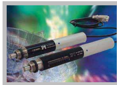
Aktives Spiegelsystem für das Keck Outrigger Teleskop in Hawaii. Die Systeme werden von einem Hochleistungs-Digitalcontroller mit einem faseroptischen Interface (nicht gezeigt) gesteuert. Spiegeldurchmesser: 250 mm Kippbereich: \pm 150 \mu\text{rad} Auflösung: Nanoradian-Bereich Positionsmessung: kapazitiv
