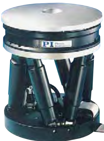
Aktiver Sekundärspiegel für NASA Infrared Teleskop Facility (IRTF) auf Mauna Kea, Hawaii, mit Hexapod 6-D-Justiersystem
