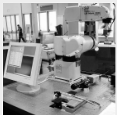
Mikrorobotik trifft Industrieroboter: PIs F-206 Hexapod – im Vordergrund in den Tisch eingelassen – optimiert über automatische Faserarray Routinen die Lichtintensität zur Herstellung optischer Bauteile. Die Bauteile werden durch den Industrieroboter von FANUC – im Bild im Hintergrund – zur Verarbeitung bereitgestellt.
