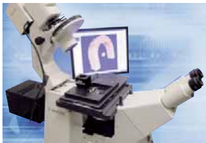
Die Funktionsweise des Mikrofertigungssystems basiert auf der sogenannten „Zwei-Photonen-Absorption“ (Foto: Teem Photonics)
