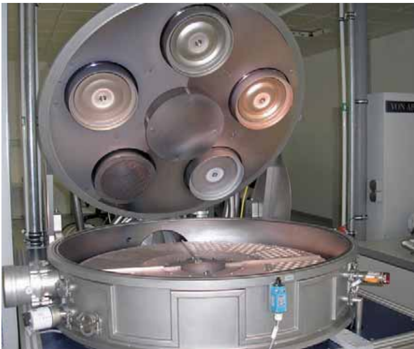
Vakuum-Beschichtung (Sputtern) von Piezokeramiken bei PI Ceramic
