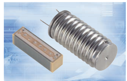
Zwei Varianten des PICMA® Piezoaktors (5 x 5 x 18 mm): Klassischer Multilayer-Aktor und mit Edelstahlgehäuse zur hermetischen Versiegelung für zusätzlichen Schutz gegen Feuchtigkeit
