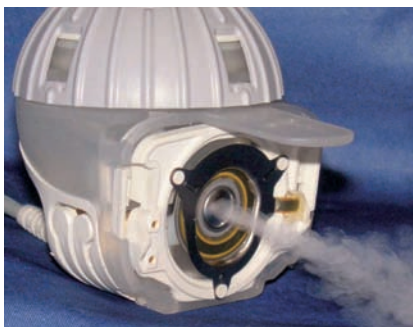
Eine ringförmige Piezoscheibe dient als Ultraschallwandler zur Aerosolerzeugung im Verneblerkopf der eFlow® rapid Electronic Nebulizer Serie (Quelle: Pari Pharma GmbH)
