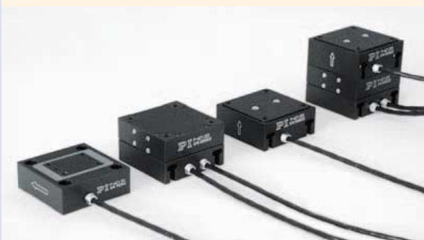
Die neue PIHera™ Piezo-NanoPositioniertisch-Familie: P-621.1CL, X-Tisch, P-621.2CL, XY-Tisch, P-621.ZCL, Z-Tisch und XYZ Kombination (v. l. n. r.). PIHera™ Tische sind mit 50, 100, 250 und 500 \mu\text{m} Hub verfügbar. Geregelt und unregelt Versionen werden angeboten.
