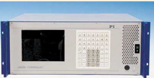
Die Steuerung der 273 Aktoren umfasst 9 spezielle C-880 Multi-Achsen-Controller mit Sonder-Interface, -Firmware und -Software.
